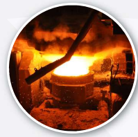
ปรับน้ำเหล็ก LADLE FURNACE (LF)
